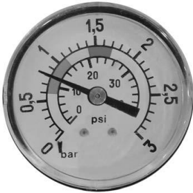
0,8 kg/cm 2 - 11,4 PSI: Normaldruck bei Beginn des Filtriervorganges.
